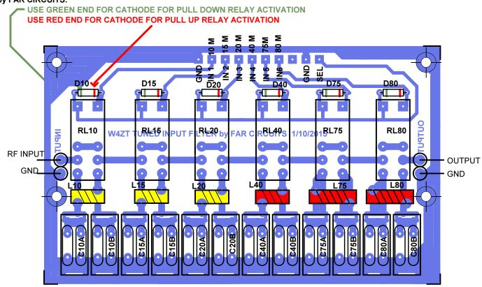
THE BOARD IS LAYOUT FOR COMPRESSION TRIMMER CAPACITORS OR DISC CAPACITORS
