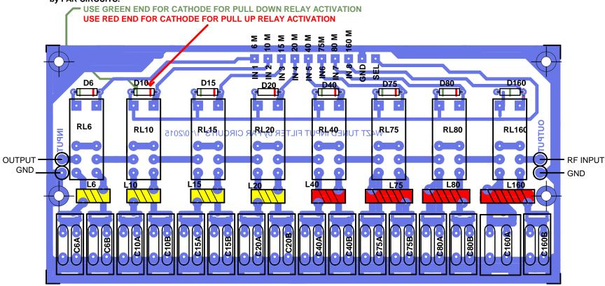
THE BOARD IS LAYOUT FOR COMPRESSION TRIMMER CAPACITORS OR DISC CAPACITORS
